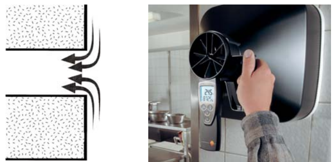
吸気口は180°流れが起こるため、ファンネルで吸気を集めて風量を測定します
