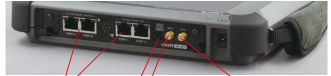
LAN計測ポート 外部入出力用端子 GPSアンテナ用コネクタ PPS信号用コネクタ
