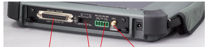
RS-232C/RS-530 計測ポート TTL計測ポート/外部トリガー端子 RS-422/485 計測ポート GPSアンテナ用コネクタ
