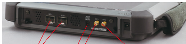
SFPモジュール接続ポート 外部入力用端子 GPSアンテナ用コネクタ PPS信号用コネクタ
