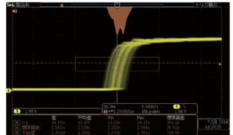
ヒストグラム表示により、時間軸と電圧軸の統計測定の実行が可能。- Mean, max, min, 標準偏差などの測定が可能
