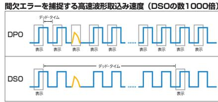
アナログ・オシロスコープ (ART) では波形の保存、解析ができません。また従来のデジタル・ストレージ・オシロスコープ (DSO) では波形の頻度情報を表示できず、デッドタイムが長いので、間欠エラーの捕捉に不向きです。MDO3000シリーズ搭載の新DPO機能は、DSOの数倍、従来比5倍の波形取込みが可能。間欠エラーも見逃しません。また、上位機種でサポートされていたカラー・グレーディングも採用されました。
