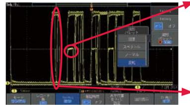
新機能の反転表示機能を使うと、稀にしか来ない信号を強調して表示します。波形がわかれば、MDOの持っている強力なトリガ機能で、間欠現象も簡単に補正可能です。
