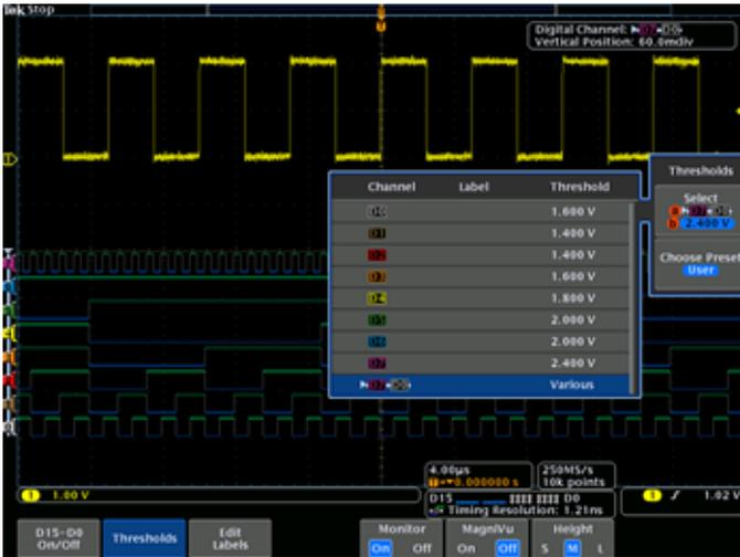
デジタル波形はカラーコードによって表示され、デジタル波形を隣り合わせに配置してグループを作成すれば、グループ内のすべてのチャンネルをまとめてポジショニング可能。
