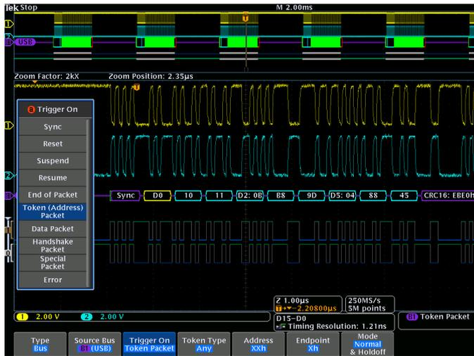
USB フルスピード・シリアル・バスの特定の OUT トークン・パケットにトリガした例。黄色の波形は D + を、青色の波形は D - を示す。バス波形は、スタート、シンク、PID、アドレス、エンド・ポイント、CRC、データの値、ストップなど、デコードされたパケットの内容を表示
