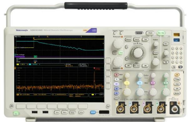
MDO4000Cシリーズは、作業が簡単になるように設計されている。大型、高解像度タッチスクリーン・ディスプレイにより複雑な信号でも細部まで表示可能。前面パネルの専用ボタンにより、操作は簡単。前面パネルに2つのUSBホスト・ポートが装備されているため、スクリーンショット、機器の設定、波形データなどをUSBメモリに簡単に保存できる。
