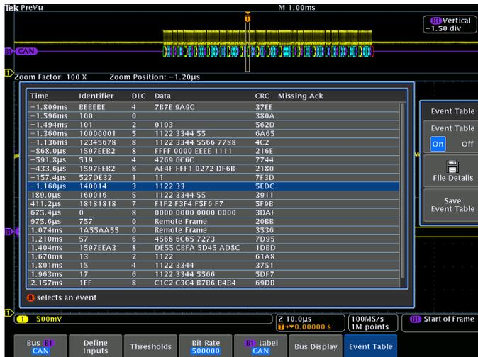
イベント・テーブル表示では、ロング・メモリに取込まれたすべてのCANパケットの識別子、DLC、データ、CRCが、トリガからの時間表示とともに表示される
