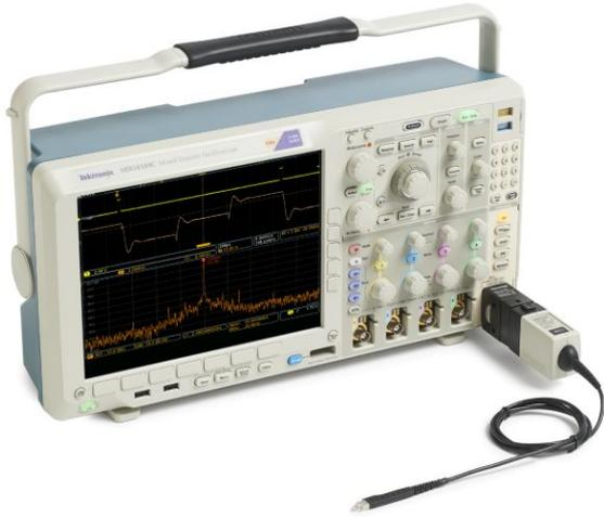
オプションの TPA-N-VPI 型アダプタを使用することで、50 $\Omega$  TekVPI インタフェース対応のアクティブ・プローブを RF 入力コネクタに接続できる
