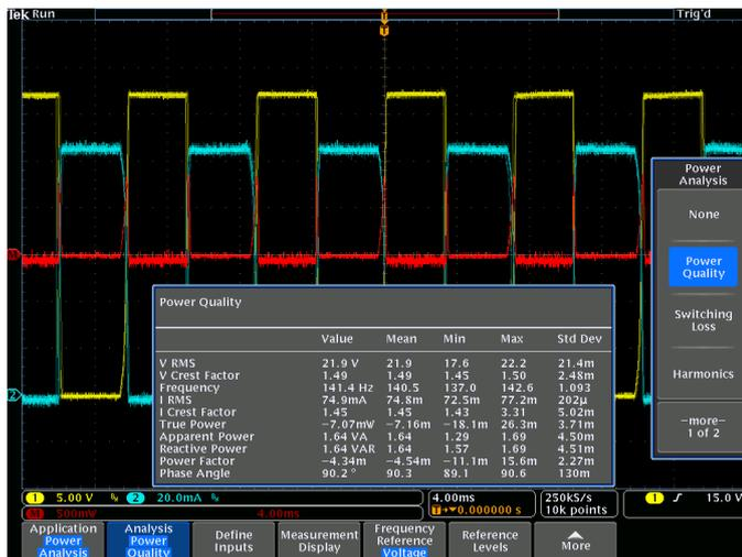
電力品質測定：パワー解析オプションにより、パワー回路のパラメータを簡単に、正確に測定可能
