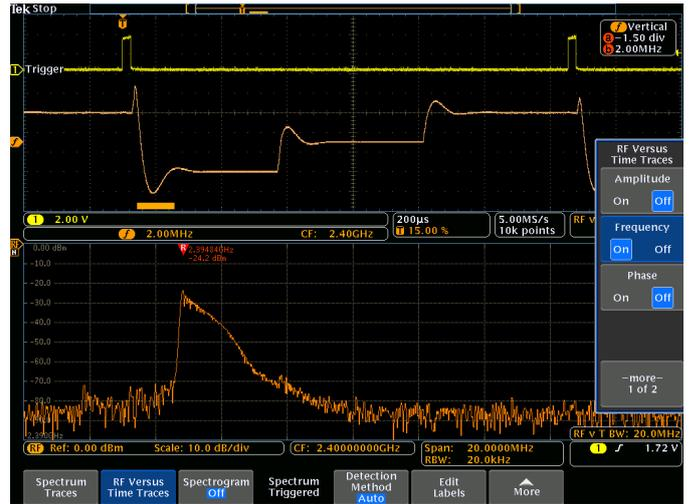
時間ドメインのオレンジ色の波形は、スペクトラム・アナライザに入力された RF 信号からの周波数対時間の波形。スペクトラム・タイムは最も高い周波数から最も低い周波数へのトランジションにあるため、エネルギーはいくつかの周波数に拡散されている。周波数対時間波形から、さまざまな周波数へのホッピングが容易にわかり、デバイスが周波数を変更するときの特性評価が簡素化できる
