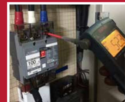
SELFモードで始業点検後、操作なしでそのまま電圧測定可能 漏電ブレーカーを落とす等の事故を防止。
