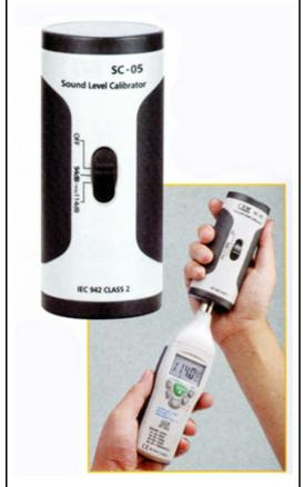
SC-05 は、騒音計が正しく作動しているかの確認や騒音校正(騒音値の補 正)のために使用する騒音校正器です。SC-05 は正確な騒音シグナル(94 dB と 114 dB)を発生します。
