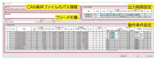
例:CANデータベースの登録設定画面* BMU連動で使用するCAN出力制限、CAN動作条件が設定できます。
