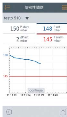
配管の気密性試験 圧力変化、経過時間、初期値、現在値も1画面で表示
