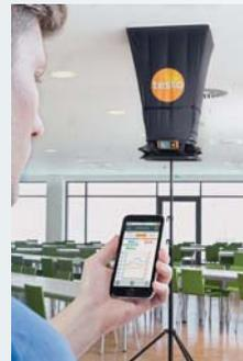
三脚を使って高所排気口で測定 差圧計としても使用可能
