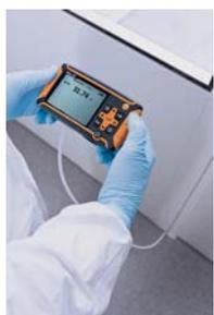
testo 420は、本体をマウントから外して差圧計として使用することもできます。差圧センサにチューブとピトー管を接続して風速を演算することもできます。通常のポータブル測定器と異なり、自動でゼロ調整（1~20秒間隔）を行うので、長時間連続記録などもできます。
