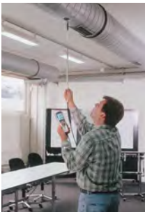
空調設備の風速・風量
