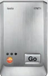
**新価格** testo 176T1は、メタルハウジングで完全防水・防塵の温度ロガーです。Pt100温度センサを内蔵しており、±0.2℃、分解能0.01℃で測定するので、高精度の温度測定を求めるアプリケーションにも対応します。
