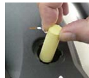
排ガス測定ボックス用 スベアフィルタ (型番:0554 3381)
