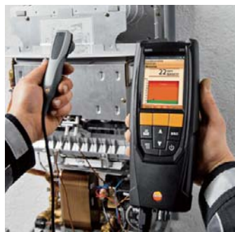
大気COプローブを使い、燃焼設備周辺にCOガスの漏れがないかを検知
