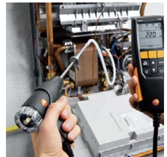
付属のシリコンチューブを使って差圧測定も可能
