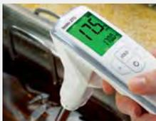
◀ 測定が終了するとディスプレイにフライ油の劣化度が数値表示され、劣化の状態が色で表示されます
