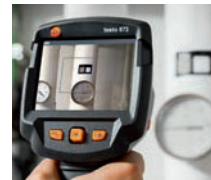
可視カメラでマーカ―を検知し、放射率と反射温度を自動設定します。
