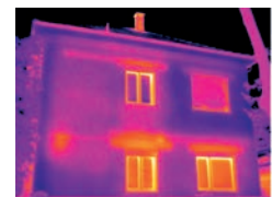
スケールアシストあり 適正化されたスケールで建物の温度が表示され、最高/最低温度箇所を見つけやすい
