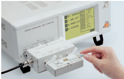
9268 または 9269 使用の際は、外付の定電圧源、定電流源が必要になります。
