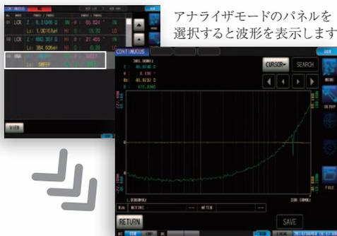
アナライザモードのパネルを選択すると波形を表示します
