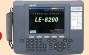
大型ディスプレイ搭載の電池駆動通信アナライザーの最上位モデルです。
