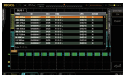
シリアルバストリガ/デコード機能(CANバス信号、表形式表示)
