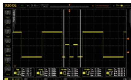
自動計測機能(カーソルで測定エリアを指定可能)
