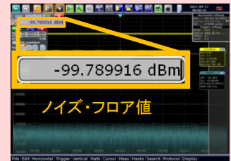
R&S®RTO のノイズ・フロアの測定値は約-100 dBm (RBW = 100 kHz)
